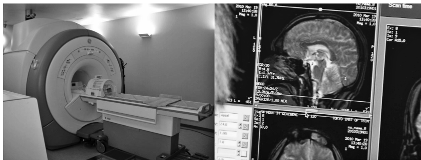
図5 本実験で使用したMR装置（GE社製、1.5T）と撮像画像の一部
